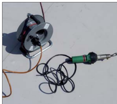
Fig. 6: Saldatura termica del manto nuovo al manto esistente ( Sarnafil® TS 77-18 ) Edificio Meusburger a Wolfurt (Austria)
