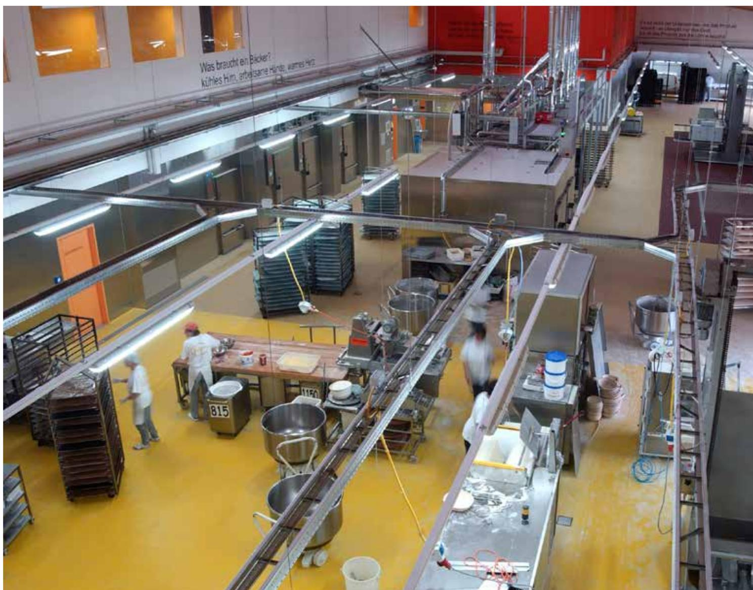
Un pavimento funzionale ed appositamente costruito è la chiave per un ambiente di produzione sicuro ed igienico. Pavimenti igienici, antiscivolo, facili da pulire e durevoli sono la base per un ambiente di lavoro ottimale.
